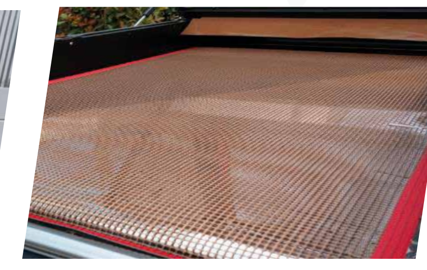
Aplicador de cola com sistema de esteira.
